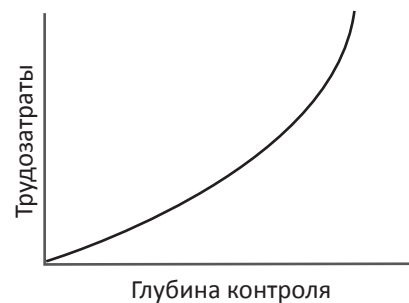
Рис 14. Зависимость трудозатрат при контроле проектов от глубины контроля.
