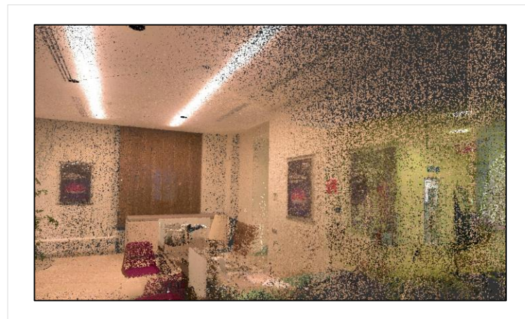
Облако точек (вид внутри помещения)
